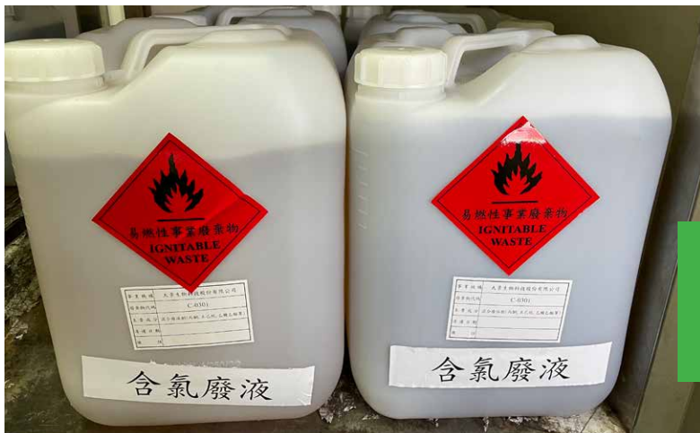
化學實驗室之廢液貼上廢液混和表及警告標示後集中暫存，待承包廠商進行後續處理。
